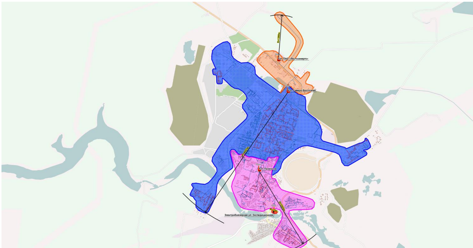
Рисунок 4. Радиус эффективного теплоснабжения источников теплоснабжения
