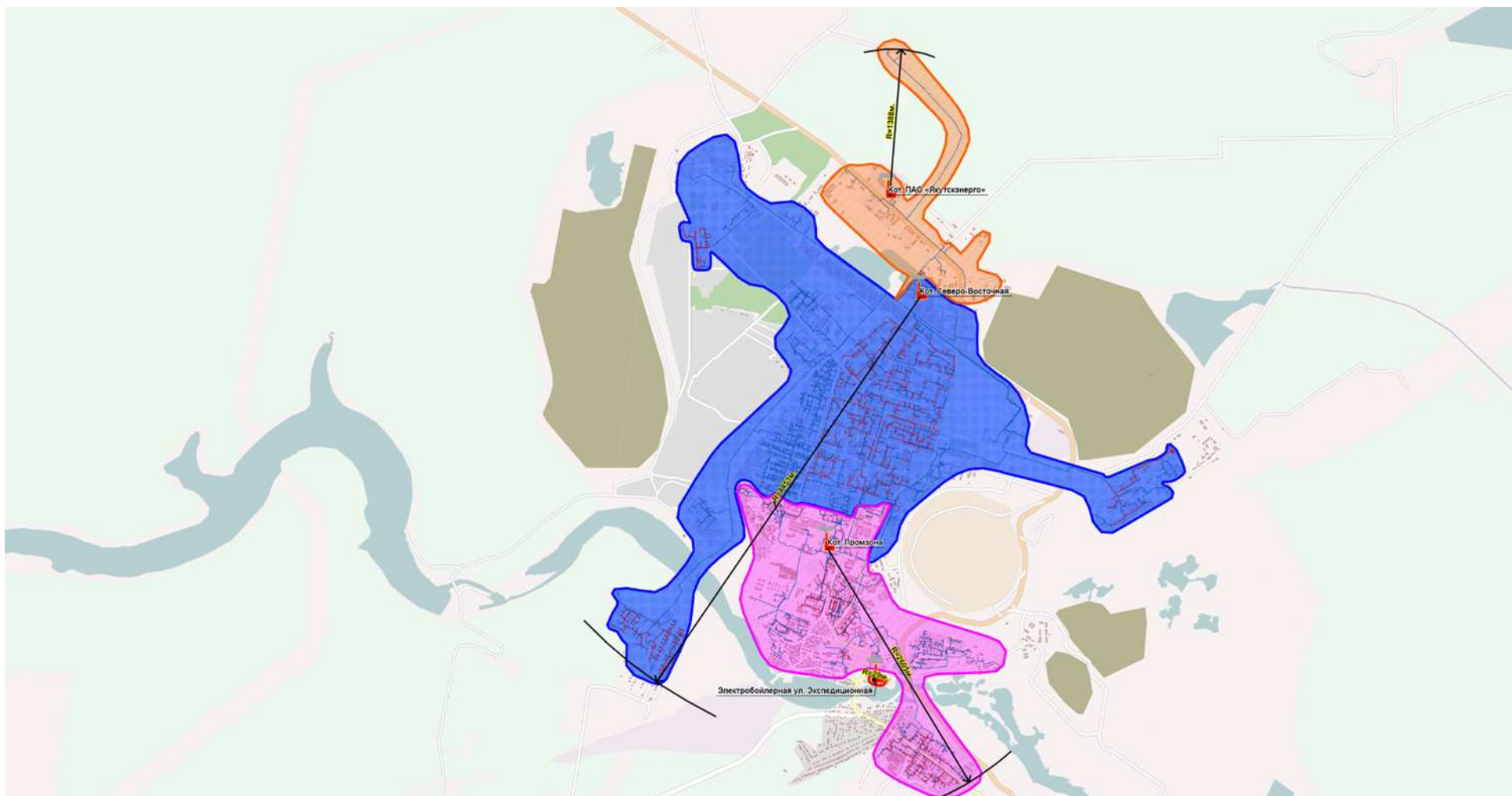
Рисунок 10. Радиус эффективного теплоснабжения источников теплоснабжения
