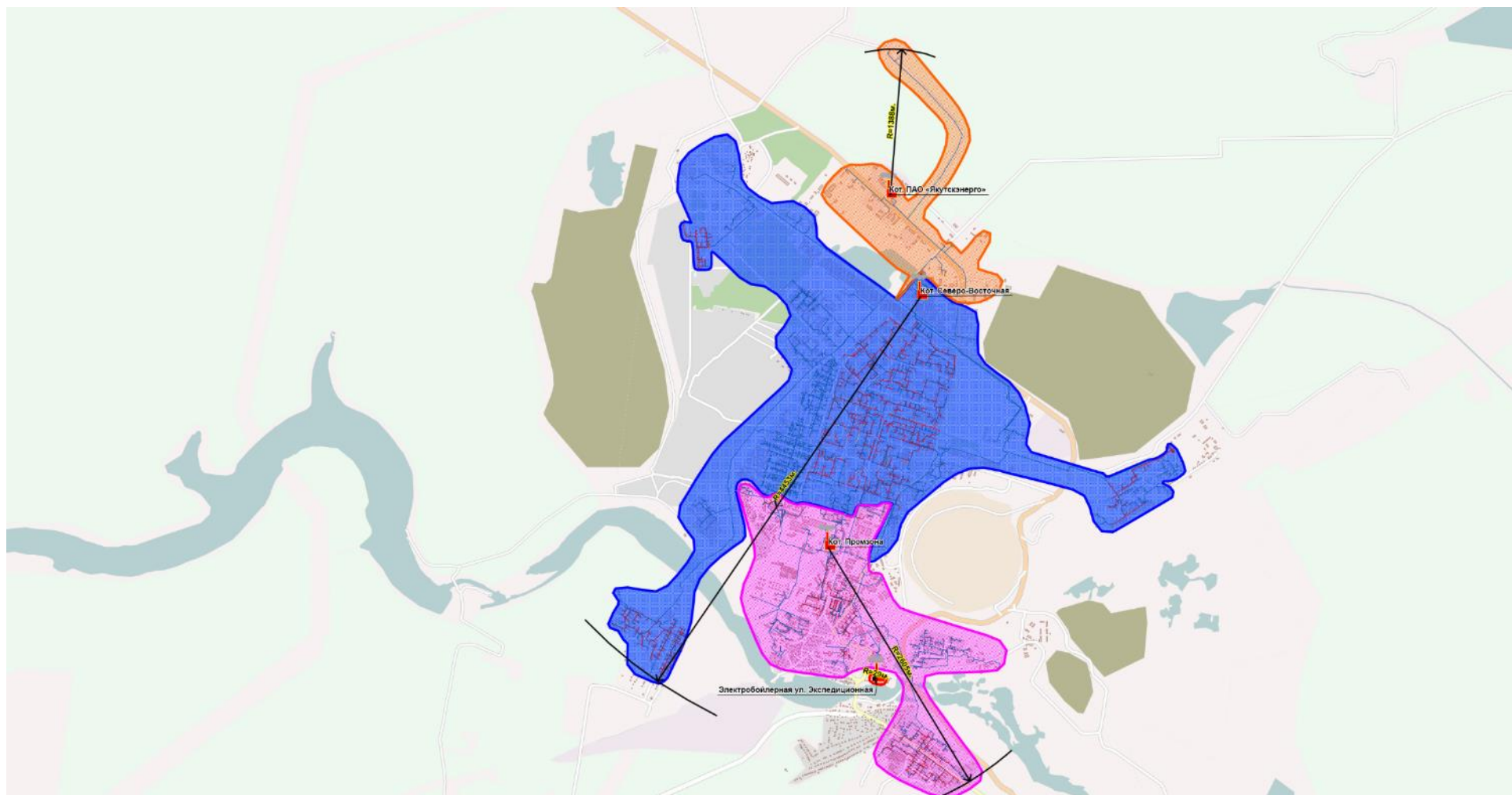
Рисунок 8. Радиус эффективного теплоснабжения источников теплоснабжения
