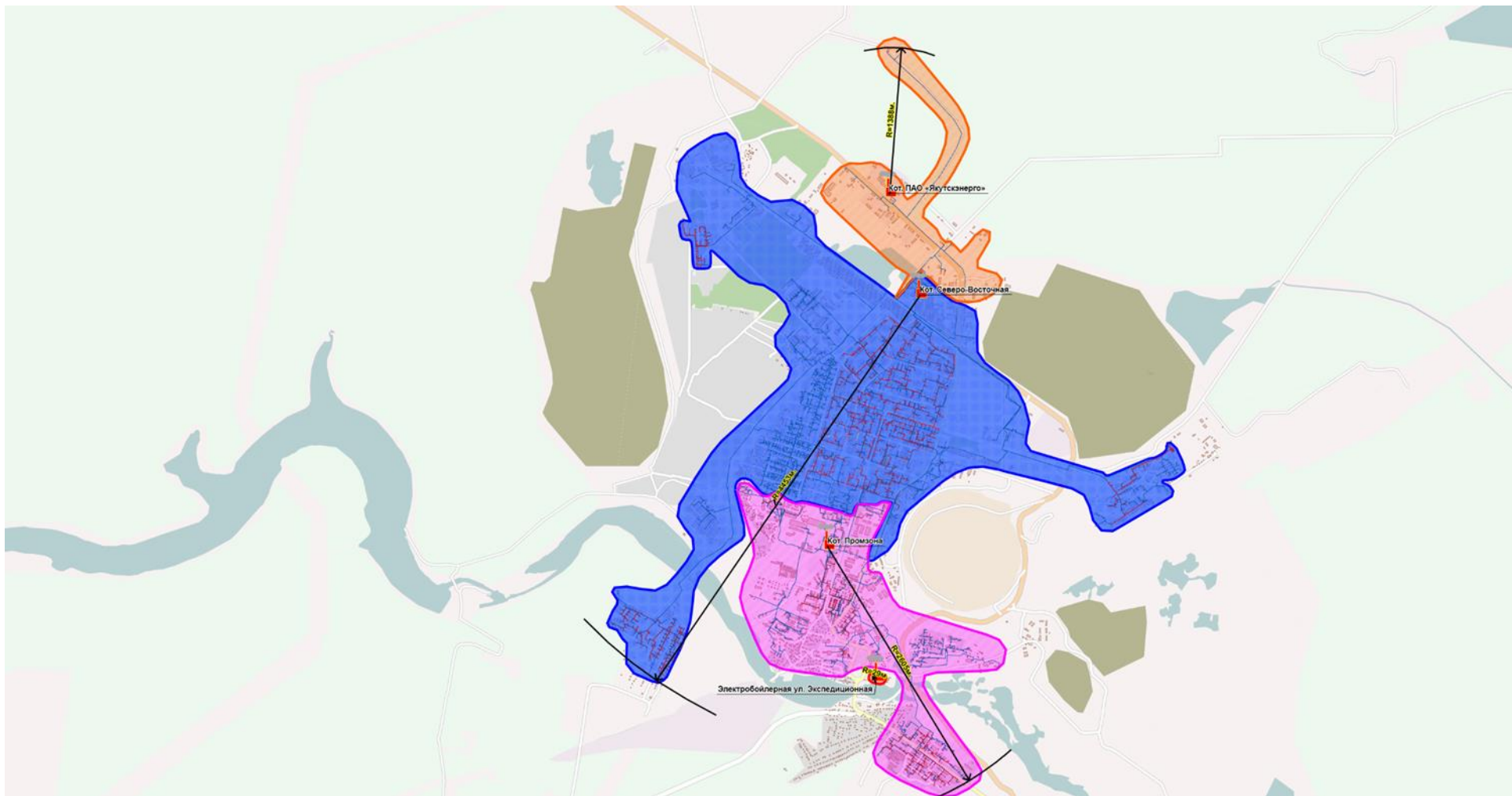
Рисунок 4. Радиус эффективного теплоснабжения источников теплоснабжения
