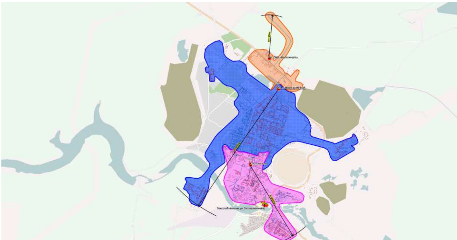
Рисунок 14. Радиус эффективного теплоснабжения источников теплоснабжения
